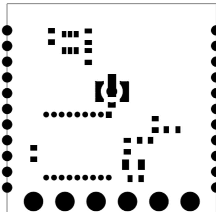
FIGURE 8 - INTERFACE ADAPTOR BOARD SOLDER MASK
