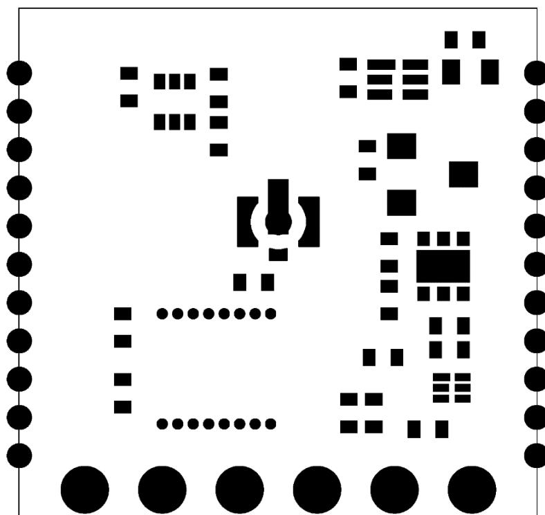
FIGURE 8 - INTERFACE ADAPTOR BOARD SOLDER MASK
